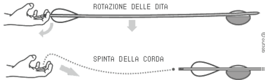
Fig.7 – Innesco della prima flessione della freccia
