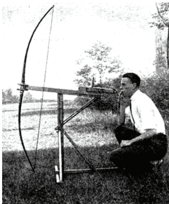
L'Autore con la macchina di tiro che ha progettato per testare le frecce. Questa macchina fu utilizzata insieme ad un cronografo per misurare la velocità e l'accelerazione. Era provvista di sgancio pneumatico.
